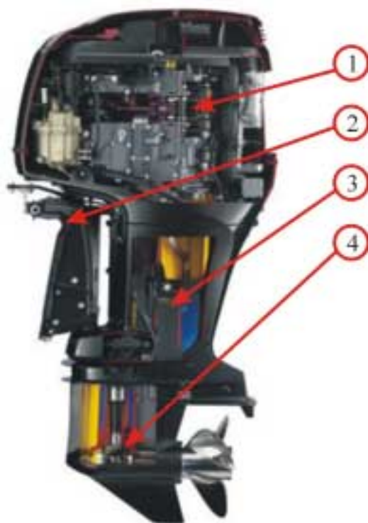
Rys. 3. Przekrój silnika firmy Suzuki, model DF 250 ZX [4]
