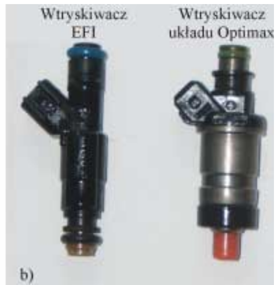
Rys. 17. Budowa wtryskiwacza układu wtryskowego EFI (a) oraz porównanie wtryskiwaczy typu EFI i (b) wtryskiwacz z układu Optimax: a) zawór iglicowy, b) dysza, c) końcówka wtryskiwacza, d), g), m), s) O-Ring, e) nasadka zaworu iglicowego, f) rdzeń, h) sprężyna, i) obudowa, j) uzwojenie cewki, k) taśma, l) szpula, n) pierścień wewnętrzny, o) nakładka, p) przyłącze, q) wtyczka, r) filtr
