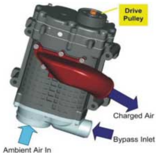
Rys. 23. Sprężarka mechaniczna silnika Verado Fig. 23. The Verado engine mechanical compressor
